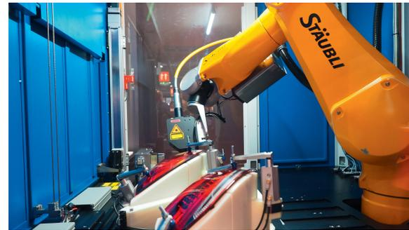
**Bild 3.** Blick in die Workstation zum Laserschweißen von Leister: auf der K mit einem 6-Achs-Roboter ausgestattet. © Hanser/Schröder
